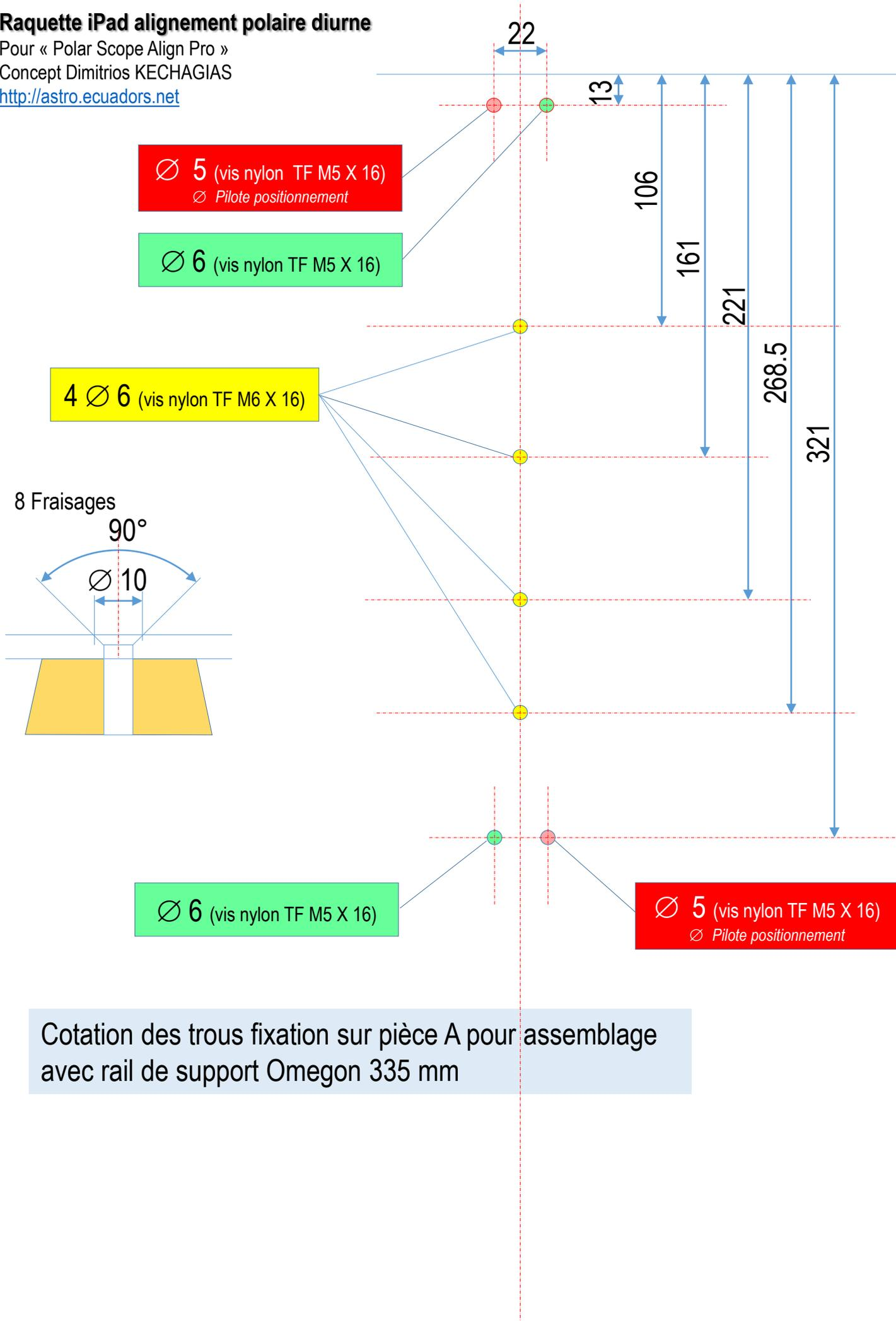
Cotation des trous fixation sur pièce A pour assemblage avec rail de support Omegon 335 mm
